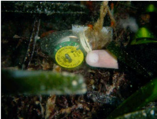
fácil de localizar. Se debería poner algún tipo de hito discreto para poder encontrar de nuevo el data logger (4 cm) en medio de la mata de Posidonia. En su defecto se puede anclar el aparato a una de las barras de las parcelas de demografía de haces.
